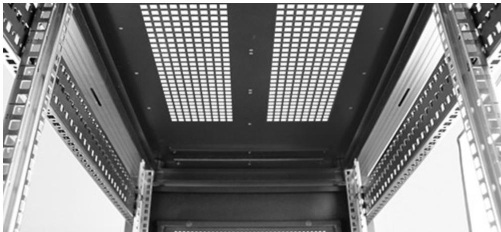
Passive Kühlung (der Luftstrom im Rack wird durch die aus einem Gitter bestehende Hintertür und die vordere, belüftete Glastür erhöht) ist kosteneffektiv und sorgt dafür, dass Ihre Geräte bei einer optimalen Temperatur laufen.
